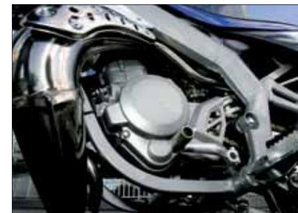
Chasis de acero de alta resistencia. Sistema de escape de acero inoxidable/Telaio in acciaio altoresistenziale. Sistema di scarico completamente in acciaio inossidabile/High-tensile steel frame. Completely stainless steel exhaust system.
