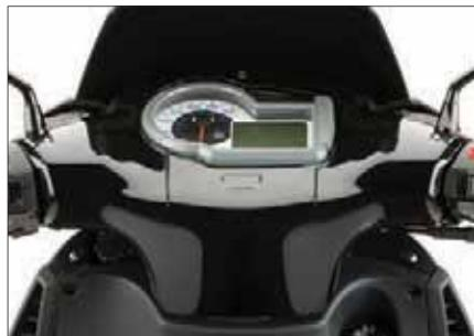
Tablero analógico digital LCD. Salida de aire caliente tras el escudo frontal y conexión de 12 V para que puedas recargar tu teléfono móvil/Cruscotto analogico digitale LCD. Fuoriuscita di aria calda dietro allo scudo frontale e presa da 12V per ricaricare il cellulare/Digital analogue LCD dashboard. Hot air outflow behind the leg shield and 12V power socket to recharge your mobile phone.
