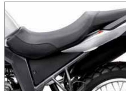
Asiento de gran tamaño y chasis de doble viga de acero/Sella di grandi dimensioni e telaio a doppio trave in acciaio/**Big size seat and steel double-beamed frame.**
