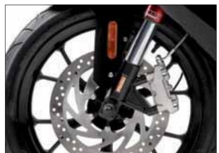
Horquilla delantera invertida Ø 41 mm con barras anodizadas en un atractivo color rojo/Forcella anteriore rovesciata da Ø 41 mm. con barre anodizzate di color rosso/Ø 41 mm inverted front fork with attractive red-anodized bars.
