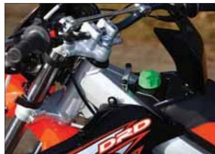
Ancho manillar de aluminio con barra transversal de refuerzo/Largo manubrio con traversino di rinforzo/Large aluminium handlebar with a strengthening crossbar.
