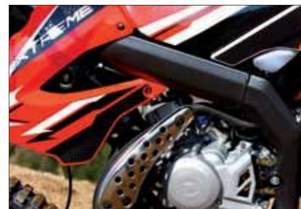
Chasis perimetral de acero de alta resistencia con doble viga/Telaio perimetrale in acciaio alto resistentiale a doppio trave/**High-strength steel double-beam perimetral frame.**
