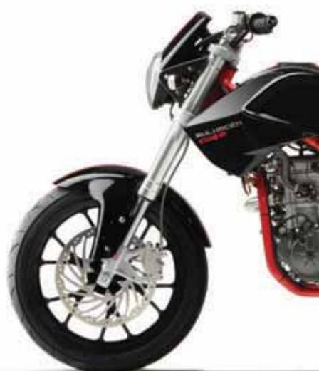
Llantas de aleación de aluminio de 17", neumáticos de carretera de composición y perfil deportivos y disco de freno delantero de 300 mm con pinza radial/Cerchi in lega di alluminio da 17", pneumatici stradali con composizione e battistrada sportivi e disco del freno anteriore da 300 mm con pinza radiale/**17"aluminium alloy wheel rims, on-road tyres with racing composition and tread and 300 mm front disc brake with radial caliper.**
