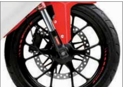
Horquilla invertida con barras de Ø 41 mm, sistema de frenos con pinza de 4 pistones de anclaje radial y disco de Ø 300 mm/Forcella rovesciata con steli da Ø 41 mm, sistema frenante con pinza a 4 pistones con ancoraggio radiale e disco da Ø 300 mm/**Upside-down fork with Ø 41 mm bars, brake system with 4-piston radial caliper and Ø 300 mm disc.**
