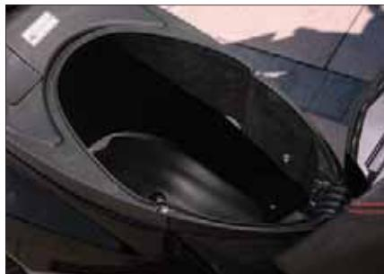
Compartimento interior bajo el asiento con espacio para guardar un casco jet, guantera porta-objetos, gancho porta-bolsas y plataforma plana/Vano sottosella che può alloggiare un casco jet, vano portaoggetti, gancio portaborse e pedana piatta/**Under-seat storage compartment for a jet helmet, storage compartment in the rear of the leg shield, bag hook and flat footrest.**
