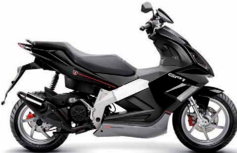
Un chasis de doble viga de aluminio de gran rigidez y monoamortiguador lateral junto a una horquilla invertida, son algunas de las opciones para obtener una estabilidad y una agilidad de referencia en el mundo de los scooters.
