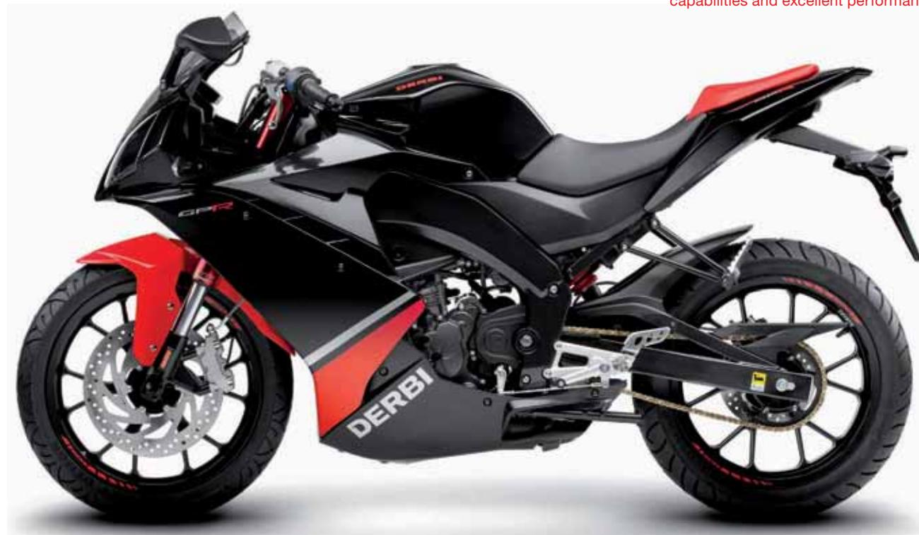
La unión de su parte ciclo –por dimensiones y componentes, con chasis de aluminio, horquilla invertida y escape integrado en quilla– con la de su motor monocilíndrico 4T 4V Euro 3, el más potente y fiable de la categoría, garantiza unas óptimas prestaciones y un excelente rendimiento.
