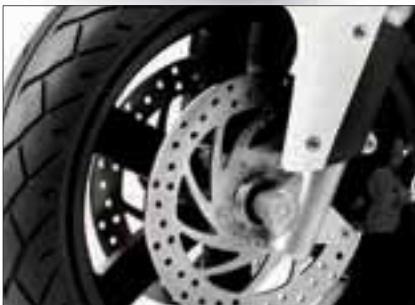
Anchos neumáticos. Sistema de frenos con disco delantero de 260 mm en la versión 125 cc -doble disco en la versión 300i- y disco trasero de 220 mm/Pneumatici larghi. Frenata precisa ed efficace grazie all'impianto frenante con disco anteriore da 260 mm nella versione 125 cc -doppio disco nella versione 300i- e disco posteriore da 220 mm/Broad tyres. Precise and effective braking thanks to a 260 mm front disc in the 125 cc version –double disc in the 300i cc- and 220 mm rear disc.
