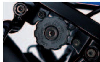
Ajuste de precarga de muelle
